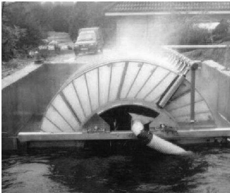
Рис. 13. Дисковый фильтр HSF2106 на ферме Lickey Bridge
